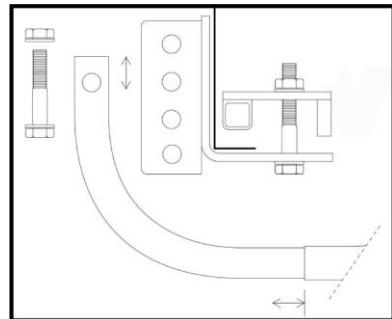
Bestimmen Sie die Endposition des Reserverades und befestigen Sie anschließend die Radhalterung (Querstrebe) mit der Gewindestange M10x85 (drehen Sie diese in die angeschweißte Mutter ein). Kontern Sie anschließend mit einer M10 Mutter, damit diese sich nicht lösen kann.
