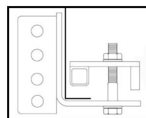
Montieren Sie nun die Chassis Montageplatte auf der gegenüberliegenden Seite (*Beifahrerseite*). Benutzen Sie dafür wieder eine M10x60 Schraube, 2 M10 Unterlegscheiben, eine M10 selbstsichernde Mutter und drehen diese wieder nur handfest an, auch diese Montageplatte soll noch verschiebbar bleiben.
