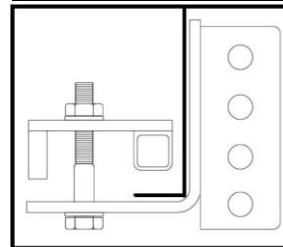
Schuif de dwarsbeugel (C), met de aangelaste moer naar boven, over de dikkere buis (B) van de uitschuifbare beugel en schuif vervolgens dunne buis (A) in de dikkere buis (B).
