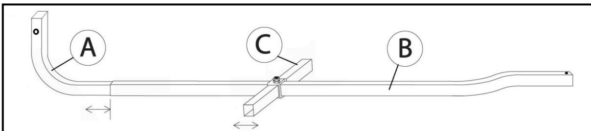
Placez maintenant tout l'étrier sous la caravane et fixez le tube le plus fin (forme en L) sur la bride de fixation du châssis de gauche à l'aide du boulon M10x60, des 2 rondelles M10 et de l'écrou d'arrêt M10 (couple moteur 5 Nm). En ce qui concerne les différentes largeurs de roues de secours et hauteurs de châssis, trois hauteurs sont disponibles. Assurez-vous que la roue de secours soit bien fixée (bride) entre l'étrier et le fond. Faites éventuellement un essai.
