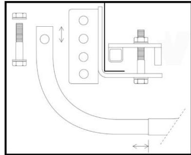
Bepaal de uiteindelijke positie van het reservewiel en borg daarna de dwarsbeugel met de M10x85 schroefdraadpen (draaien in de aangelaste moer). Borg de schroefdraadpen vervolgens met de M10 moer zodat deze niet los kan komen.
