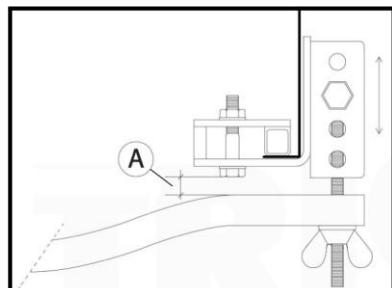
Stellen Sie sicher, dass das System in der richtigen Position ist, das Rad keine wichtigen Teile berührt und gut zwischen der Unterseite des Wohnwagens und der Halterung geklemmt ist. Anschließend die Schrauben der Chassis Montageplatten fest anziehen (Drehmoment 25Nm).
