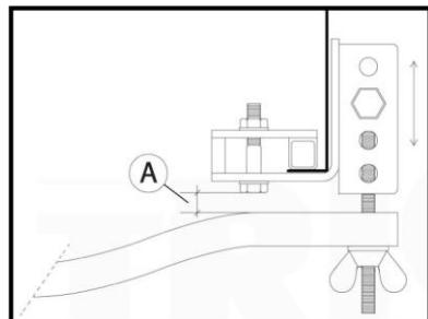
Controleer of het hele systeem op de juiste positie zit, de band geen cruciale onderdelen raakt en goed klem zit tussen de bodem en de beugel. Draai vervolgens beide chassis bevestigingklem bouten definitief vast (aandraaimoment 25Nm).
