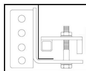
Montez ensuite la bride de fixation du châssis sur le côté droit du châssis (*côté passager*). Utilisez pour ce faire le boulon M10x60, les 2 rondelles M10, l'écrou d'arrêt M10 et fixez-les à la main, de sorte qu'il soit encore possible de faire glisser la bride de fixation du châssis.
