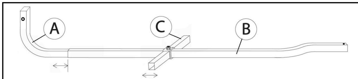
Plaats nu de complete beugel onder de caravan en bevestig de dunnere buis (L-vorm) aan de linker chassis bevestigingsklem door middel van de M10x60 bout, 2 M10 ringen en M10 borgmoer (aandraaimoment 5Nm). In verband met de verschillende reservewiel breedtes en chassishoogtes zijn er drie hoogtes beschikbaar. Zorg ervoor dat de reservewiel uiteindelijk goed vast (klem) komt te zitten tussen de beugel en de bodem. Eventueel even uitproberen.
