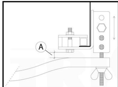
Contrôlez si tout le système est bien positionné, que le pneu ne touche pas d'éléments cruciaux et soit bien serré entre le fond et l'étrier. Serrez ensuite les deux boulons de la bride de fixation des deux châssis (couple moteur 25 Nm).
