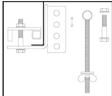
Pour un fonctionnement optimal et sûr (le bon serrage de la roue de secours), il est important de maintenir un espace de 10 mm entre le boulon de la bride de fixation du châssis et l'étrier (A). Si nécessaire, remplir l'espace entre le pneu et le fond avec une latte en bois.
