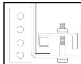
Monteer daarna de chassis bevestigingsklem aan de rechter chassiszijde (*bijrijderkant*). Gebruik hiervoor de M10x60 bout, 2 M10 ringen, M10 borgmoer en bevestig deze "handvast", zoodanig dat de chassis bevestigingsklem nog net verschoven kan worden.
