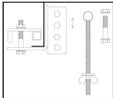
Für eine optimale und sichere Funktion (richtige Klemmung des Ersatzrades) ist es wichtig, dass zwischen der Schraube der Chassis Montageplatte und der Halterung mindestens 10mm Abstand (A) vorhanden sind. Falls nötig, fügen Sie zwischen dem Rad und dem Wohnwagenboden eine Holzleiste ein.
