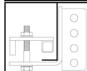
Schieben Sie die Radhalterung (C) (aufgeschweißte Muttern oben) über das äußere Rohr (B) der Teleskophalterung, anschließend das innere Rohr (A) in das äußere Rohr (B).
